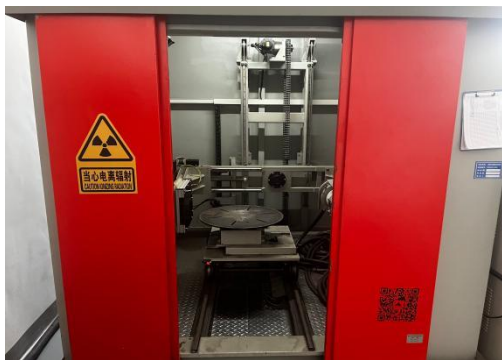
X射线实时成像检测检测系统
